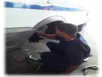
Reparación del motor de camión de transporte de personal de base de ómnibus y vistiendo banda de freno trasero y delantero al ómnibus
