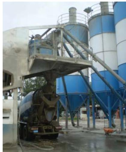
Planta de producción de hormigón premezclado con adición de zeolitas naturales a granel en Las Morlas, EPH Varadero.
