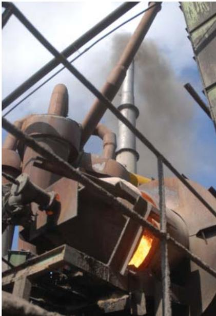
Vista del quemador que facilita la cocción de la mezcla asfáltica con los áridos para la producción de asfalto en la planta de la ECOI 30 de Sancti Spíritus.
