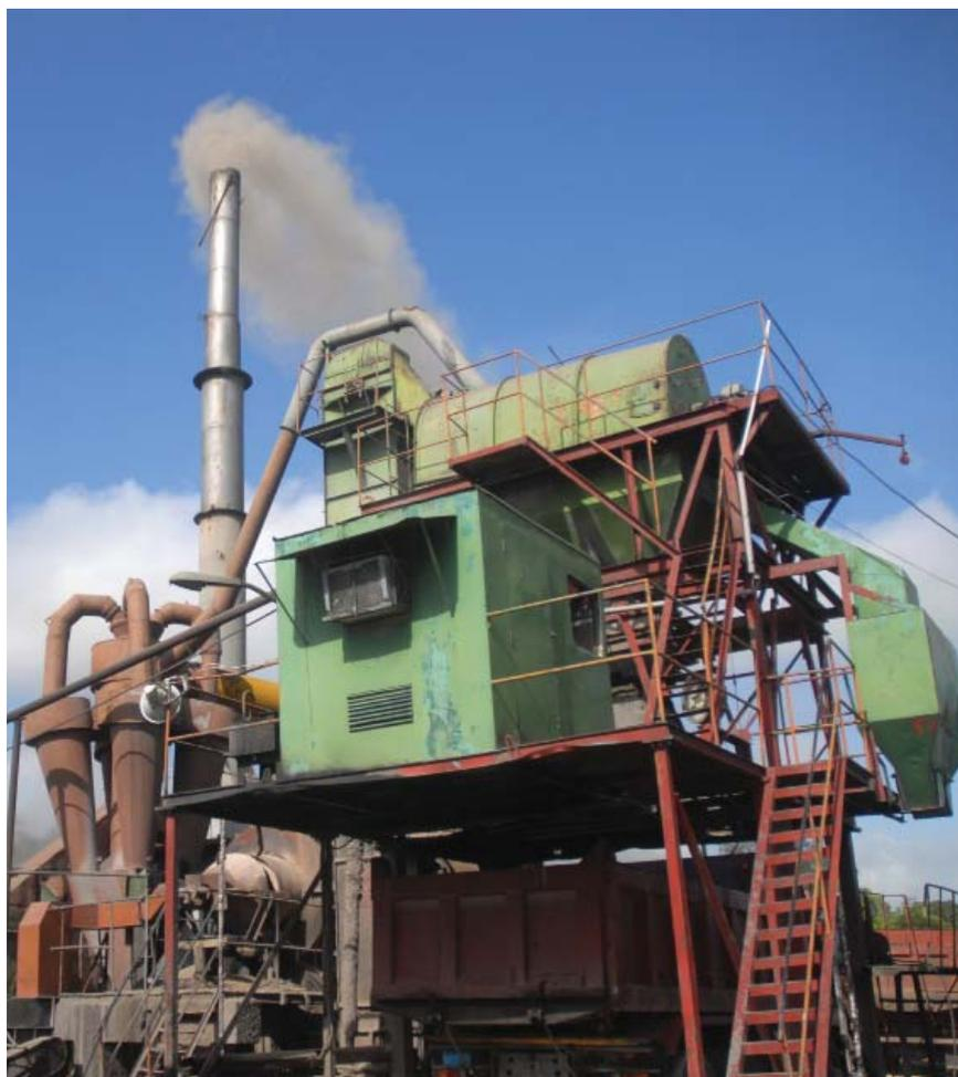
Vista del quemador que facilita la cocción de la mezcla asfáltica con los áridos para la producción de asfalto en la planta de la ECOI 30 de Sancti Spiritus.
